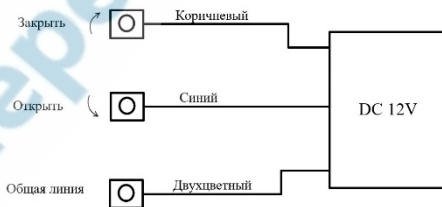
Рисунок 2 – Схема внешних подключений к крану
