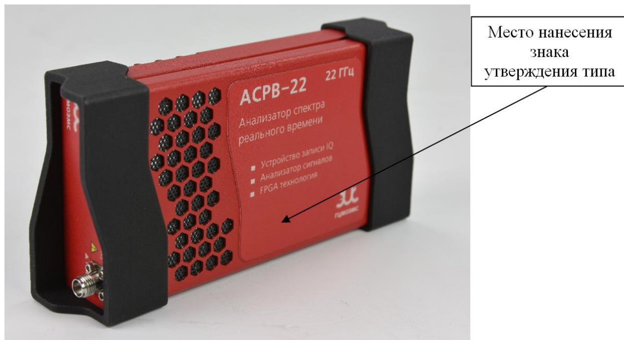
Рисунок 3 – Общий вид, место нанесения знака утверждения типа анализаторов спектра реального времени АСРВ модификаций АСРВ-20, АСРВ-22, АСРВ-40 с типом интерфейса управления и передачи данных USB
